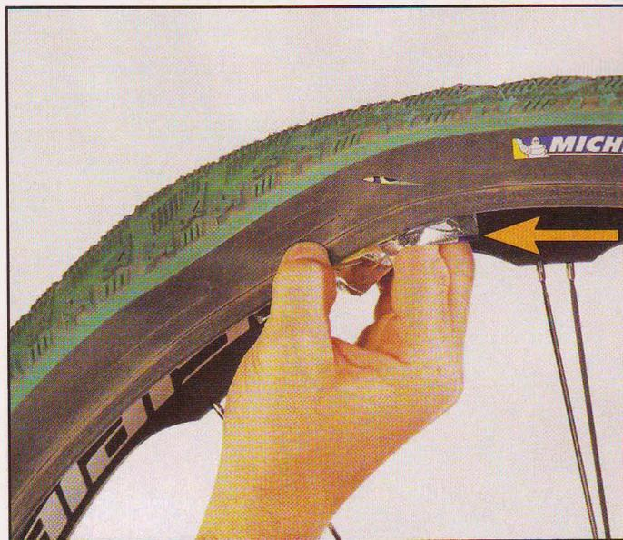
**3** Rare, mais ennuyeux : la déchirure du flanc d'un pneu ! Trouvez un intercalaire à glisser entre la chambre et le pneu pour éviter la hernie. Le meilleur reste l'emballage alu de barre énergétique. Remontez le pneu en finissant par la section abîmée. Maintenez le papier pour le coincer entre le talon du pneu et la jante.
