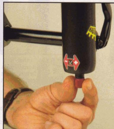
**9** Le réglage de la détente s'effectue avec la molette rouge située sous le fourreau droit. Descendez une petite marche (le bord d'un trottoir), en position assis. La fourche ne doit rebondir qu'une à deux fois. Si la fourche rebondit plus et trop vite, augmentez progressivement l'amortissement en détente („,+“). Si la fourche revient trop lentement à sa position initiale, diminuez progressivement l'amortissement en détente.
