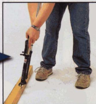
**5** Pour bien régler la détente, testez d'abord les deux réglages extrêmes (lapin et tortue), en vissant et en dévissant la molette située en bas du fourreau droit. En faisant fonctionner la fourche à plat, à l'arrêt, vous apprécierez la marge de manœuvre.
