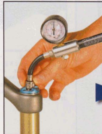
**2** Vissez l'embout de la valve de pompe sur la valve de la fourche jusqu'à ce que le manomètre indique la pression (comptez environ 6 tours). Ne vissez pas trop fort, vous pourriez endommager le joint situé sur la valve de la pompe.
