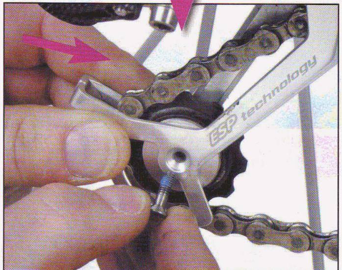
**8** Réalignez les deux plaques, glissez le galet de tension en maintenant ces pièces alignées.
