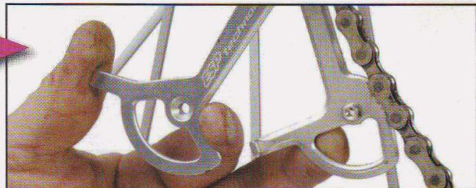
**5** Décalez les deux plaques de chape. Éventuellement, desserrez légèrement l'axe du galet supérieur. Passez la chaîne par-dessus l'ergot guide de la plaque intérieure et sortez-la.
