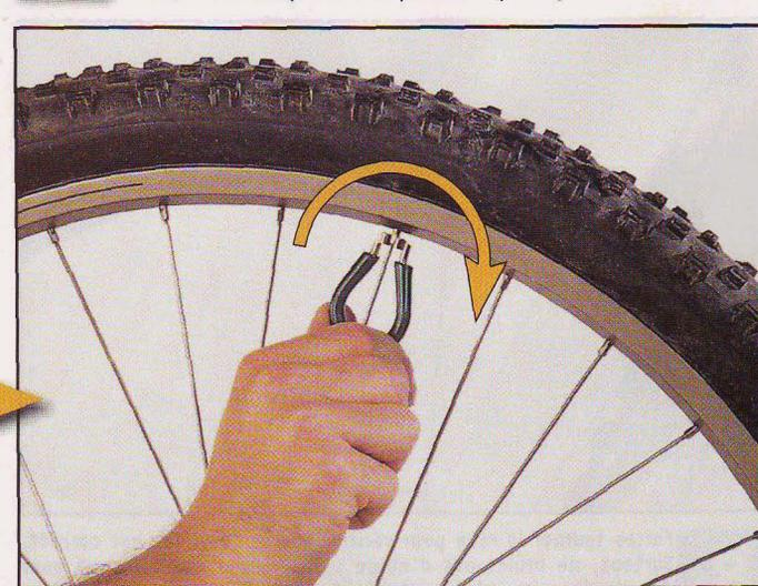
**5** Sur une roue ainsi redressée, vous allez rencontrer des zones où les rayons sont tendus à l'extrême et d'autres où ils sont lâches. Sans trop vous soucier du voile, uniformisez la tension en serrant ou desserrant les écrous avant d'attaquer un dévoilage grossier. Votre roue est "globalement" droite et consolidée. Vérifiez que le pneu ne frotte pas sur les patins et finissez votre balade. Il faudra songer à remplacer la jante dans les plus brefs délais !
