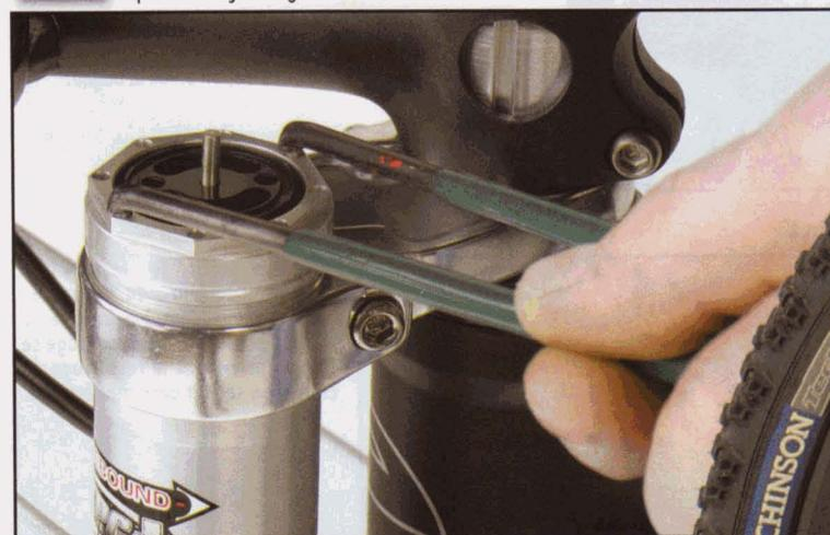
**3** Avec une clé plate de 40 mm ou une clé à ergots (modèle vert chez Park Tool) de 2 mm (à vérifier), dévissez le bouchon supérieur du jambage.
