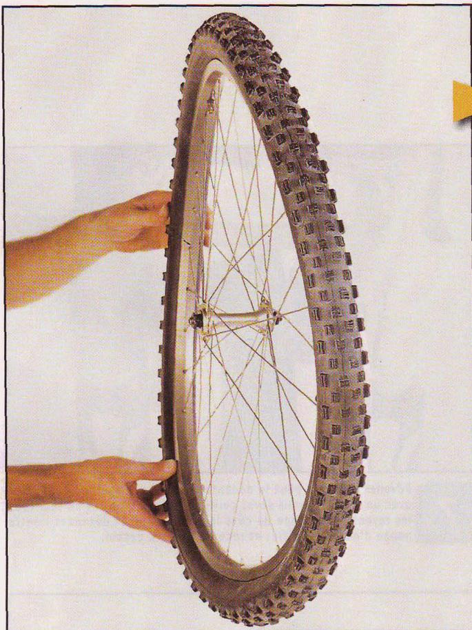
**1** Roue démontée, repérez les zones de déformation. Il faut trois points d'appui pour redresser la jante. Les deux premiers points sont vos mains. Pour le troisième, trouvez un appui naturel, type rocher plat, souche, tronc ou bordure de trottoir.
