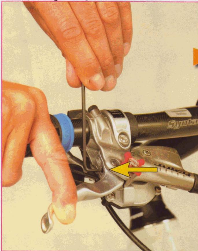
**1** Pour adapter au mieux la position de vos leviers de freins à la taille de vos mains, certaines commandes disposent d'un réglage de la garde. Vous pouvez donc régler la distance entre le cintre et le levier sans modifier le réglage du freinage.
