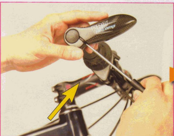
**4** Pour éviter de détériorer le guidon avec des leviers ou des embouts de guidon trop serrés, écarter légèrement ces derniers avec un petit tournevis.
