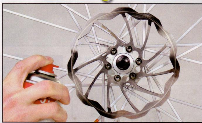
**2** Roues démontées, dégraissez vos disques des deux côtés en respectant les consignes propres au produit utilisé (endroit ventilé...). Produits préconisés : dégraissants spécifiques pour freins à disques ou produit à vaisselle.
