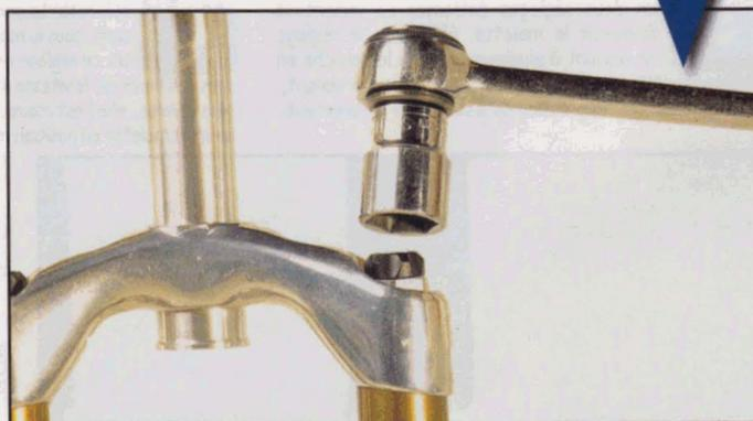
**3** Avec une clé à douille de 21, desserrez les bouchons des deux plongeurs sans avoir à démonter quoi que ce soit d'autre (excepté le petit levier sur les fourches dotées de l'ECC ou de l'ETA).
