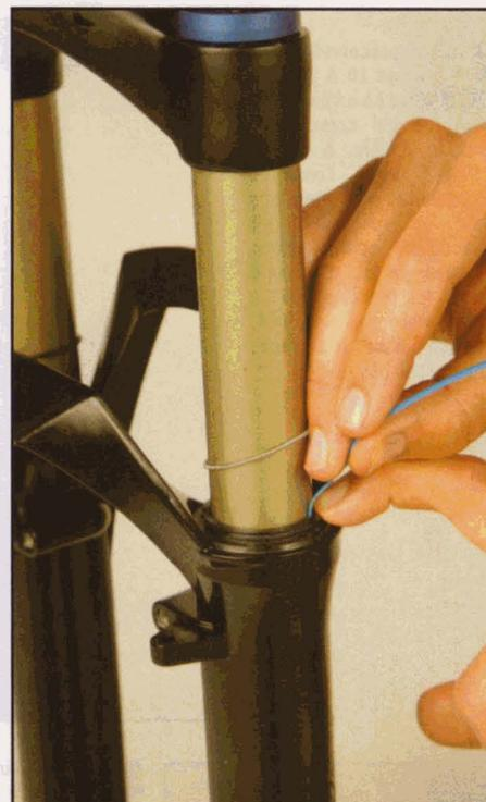
**2** Introduisez entre le joint et le plongeur l'extrémité fine et arrondie d'un collier Rilsan, puis pulvérisez du lubrifiant (Magura Ultra Slide ou Teflon). Actionnez la fourche et essuyez le plongeur et le joint racleur.
