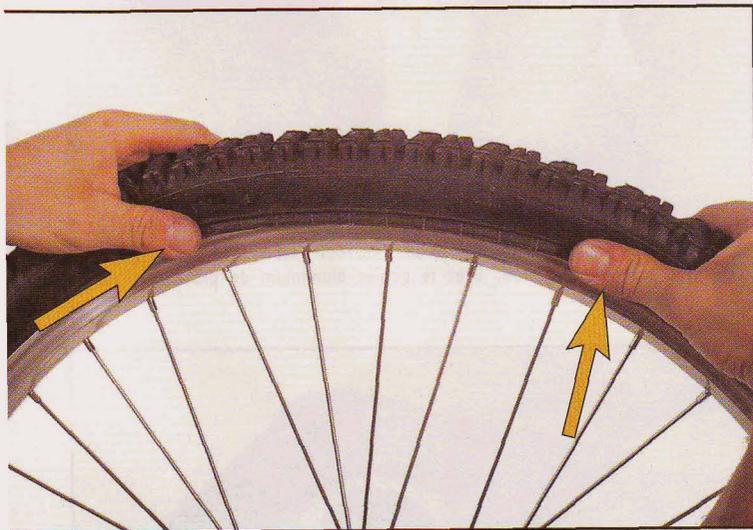
**7** Placez le talon du pneu en le poussant par-dessus la jante. Commencez par la valve. Enfoncez-la dans le pneu pour éviter que le talon pince la chambre et la crève. Continuez à placer le pneu en remontant simultanément des deux côtés. Si votre pneu est trop difficile à placer, commencez à l'opposé de la valve et finissez en poussant celle-ci pour permettre au talon de se placer. Au besoin, redégonflez la chambre. N'utilisez pas de démonte-pneus.
