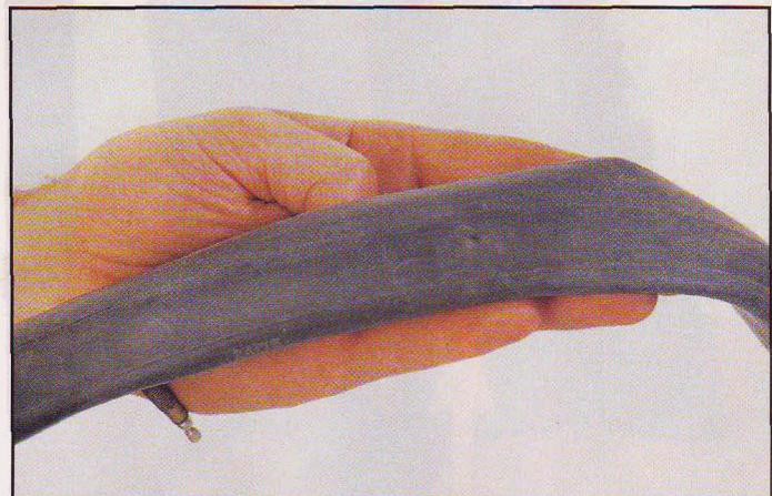
**1** Roue et pneu démontés, sortez la chambre à air. En pleine nature, sans bassine d'eau, utilisez vos sens. Si les yeux ne suffisent pas, regonflez et approchez la chambre de votre visage pour décèler un léger filet d'air.
