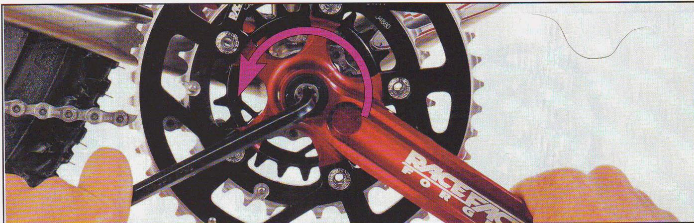
**1** Les pédaliers modernes ont un serrage par boulons à tête BTR. Utilisez une clé Allen de 8 mm avec un manche long ou prolongée par un petit tube à rallonges, pour augmenter le bras de levier. Certains pédaliers sont dotés de boulons extracteurs. Dévissez et retirez les boulons et leurs rondelles d'appui. Sur les nouveaux axes de pédalier, cannelés, un extracteur spécifique peut être nécessaire.
