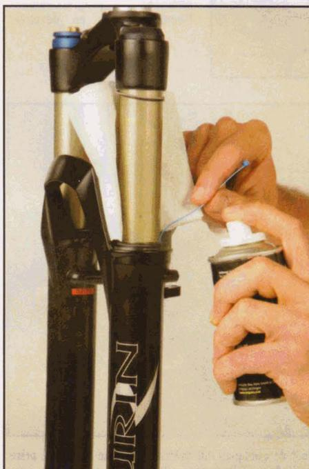
**3** Après chaque sortie, lubrifiez les plongeurs avec un lubrifiant (Magura Ultra Slide ou Teflon). Absorbent les projections avec un chiffon pour éviter de contaminer le disque. Comprimez plusieurs fois la fourche et essuyez les résidus d'huile.
