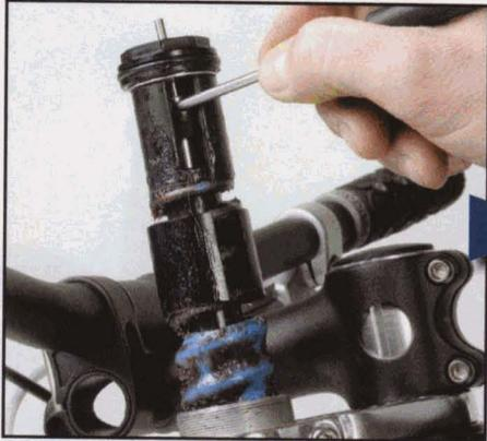
**5** Avec un petit tournevis plat, faites descendre le tampon élastomère situé sous le bouchon veillant à ne pas abîmer le piston.
