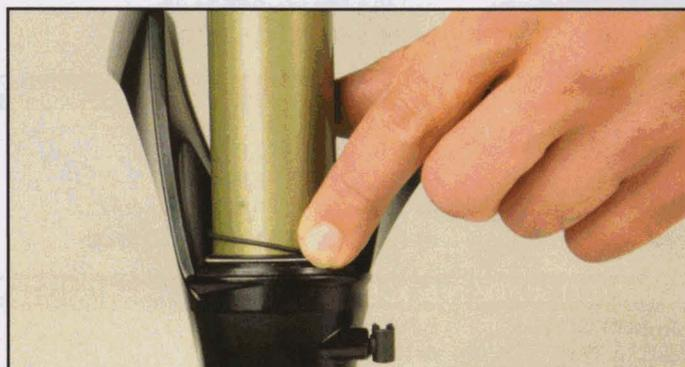
**5** Les fourches Magura sont dotées d'un joint torique pour mesurer le SAG. Faites-le glisser au contact du joint traqueur avant de commencer le réglage. Installez-vous sur le vélo, en position d'utilisation, sans à-coups, et redescendez pour mesurer la valeur d'enfoncement au repos (SAG).
