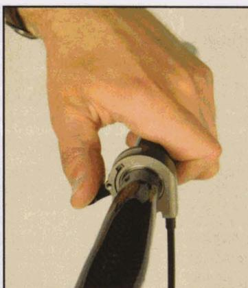
**3** Avant tout réglage, la fourche doit se trouver en débattement maximal (160 mm). Pour en être sûr, appuyez sur le levier au cintre FCR (à gauche). Si le débattement de la fourche est réduit, la fourche reviendra alors en place.
