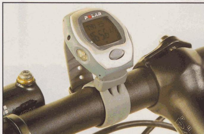
**6** Quand on n'a pas de support pour fixer son cardio-fréquence-mètre sur le cintre, il est possible de passer la partie percée du bracelet dans le passant mobile puis fermez la montre sur le cintre avec la boucle comme sur votre poignet en serrant au maximum.
