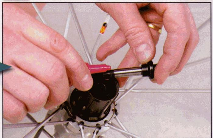
**7** Pour assurer un serrage fiable du montage, une petite goutte de Loctite sur le filetage de l'axe est conseillé.
