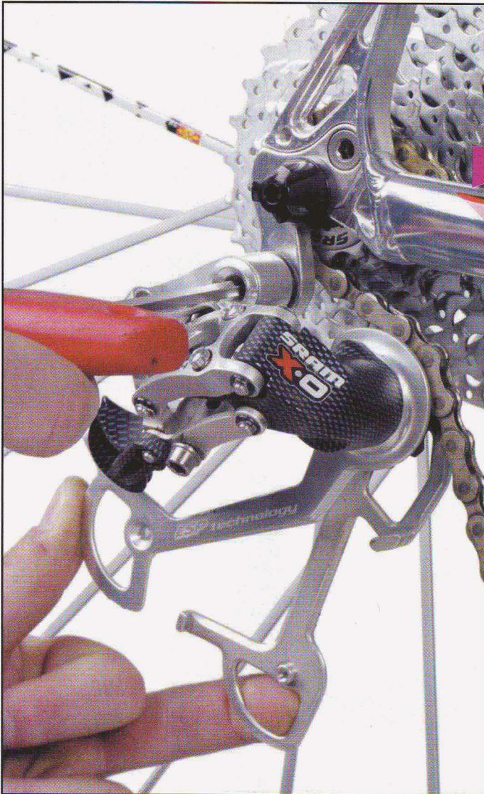
**6** Desserrez la fixation du dérailleur sur le cadre à l'aide, le plus souvent, d'une clé Allen de 5. Pour remonter le dérailleur, vissez son axe en tirant son corps en arrière, afin que sa butée de tension soit bien au-dessus de la patte du cadre.
