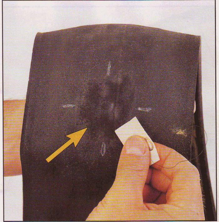
**2** Afin que la rustine puisse coller au pneu, il est impératif de nettoyer celui-ci de tous les résidus de lubrifiant utilisés lors de sa fabrication. Pour cela, essuyez la zone avec un chiffon et du Trichlo.
