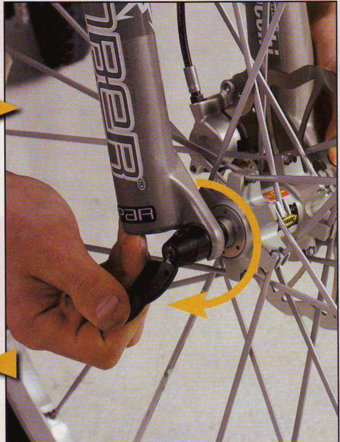
**3** Roue avant ou roue arrière, le maniement du serrage rapide est le même. La fourche nécessite souvent, pour sortir la roue, de dévisser le boulon de réglage du serrage. Au remontage, vissez le boulon "butée" d'axe, côté opposé au levier de serrage.
