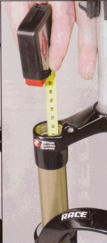
**5** Versez l'huile neuve en pompant régulièrement pour bien répartir le liquide dans le système. Particularité du Motion Control, le niveau d'huile doit se trouver à 127 mm du haut du plongeur, maximum. Quels que soient le modèle de fourche et le diamètre du plongeur, la cartouche Motion Control est toujours de longueur identique.
