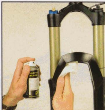
**1** Après chaque sortie, lubrifiez les plongeurs avec un lubrifiant au Teflon. Absorbés les projections avec un chiffon pour éviter de contaminer le disque. Comprimez plusieurs fois la fourche et essuyez les résidus d'huile.
