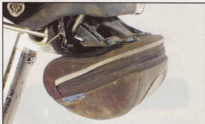
**5** Les sacoches de selle sont dotées de fixations rapides parfois mis à mal sur terrain défoncé. Assurez-les avec une sangle de cale-pied passée dans les rails de la selle, en planquant la boucle de serrage entre les rails pour ne pas vous blesser dessus.
