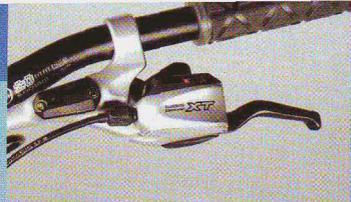
Les manettes de vitesse à gâchettes sont d'un entretien réduit. S'il vaut mieux éviter tout démontage des Shimano STI, a contrario des nouvelles Sram Trigger, le changement des câbles de dérailleur reste simple sur les deux...
