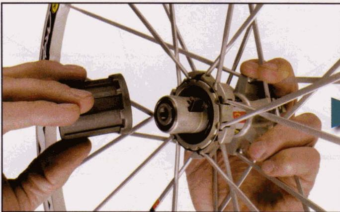
**4** Dégagez le corps de roue libre en deux étapes. D'abord, tirez dessus de 4 mm et tournez jusqu'à ce qu'il se déboîte. Attention, en le dégageant, à ne pas laisser s'échapper les deux cliquets et ressorts ainsi que la rondelle qui se cachent dessous !
