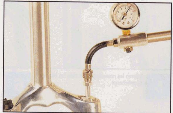
**4** Du réglage de la chambre négative dépend le seuil de déclenchement. Plus on gonfle la chambre négative, plus le déclenchement est doux. Généralement, il faut compter entre 7 et 12 bars (reportez-vous au tableau). Remontez les bouchons.
