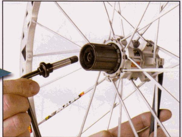
**3** À l'aide d'une clé Allen de 5, démontez l'axe support de corps de roue libre en maintenant l'autre partie à l'aide de la clé Allen de 10.
