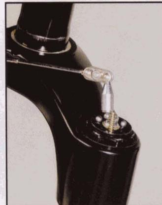
**1** À l'aide d'une clé BTR de 2,5 mm, démontez la molette de réglage du U-Turn.
