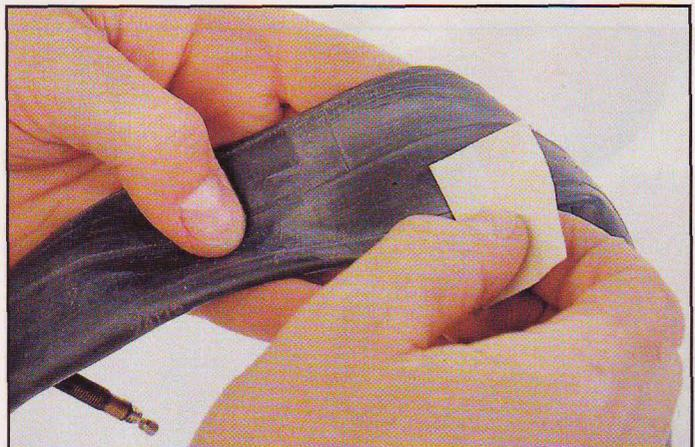
**2** Dans les kits de réparation commercialisés, vous trouverez tout le matériel nécessaire, comme la toile abrasive. Poncez la zone autour du trou pour enlever la pellicule de surface de la chambre et permettre à la dissolution d'agir.
