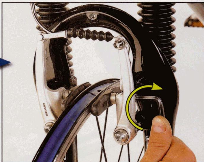
**3** Réglez les patins parallèles le plus bas possible sur les flancs de la jante. Leur bord inférieur doit être à 1 mm au-dessus de l'angle du bord de jante. Ainsi, ils ne toucheront pas les flancs du pneu durant le freinage.
