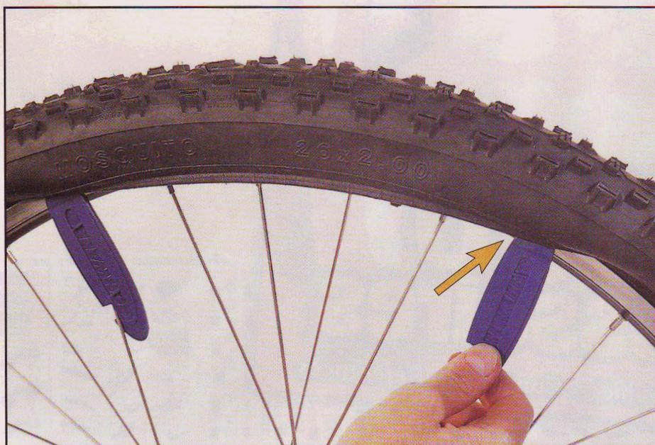
**3** Faites levier avec l'un des démonte-pneus, puis l'autre, pour faire sortir le talon du pneu.
