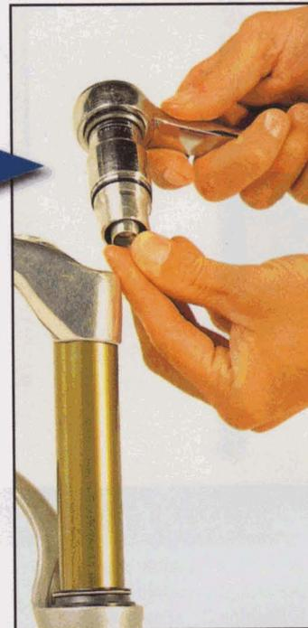
**10** Serrez le bouchon avec la clé à douille de 21, fermement mais sans forcer.
