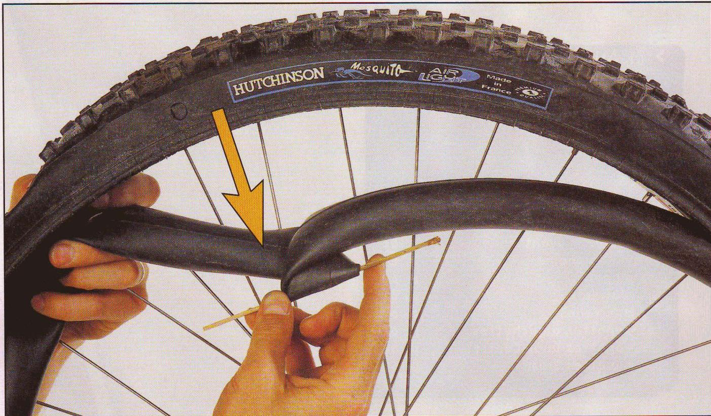
**1** Vous n'avez ni rustines ni chambre de rechange. Glissez une petite branche rigide au niveau de la crevaison et torsadez la chambre. Introduisez d'abord la valve. En jouant sur l'élasticité du caoutchouc, placez la chambre sur la jante. Grâce à la branche, la chambre reste torsadée dans le pneu et la torsade isole le trou.
