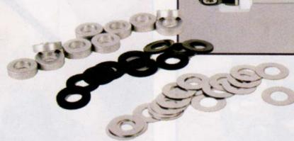
**7b** Une patte alignée ne fait pas tout, il faut également utiliser des rondelles calibrées d'épaisseur identique sous chacune des vis, pour un ajustement parfait !
