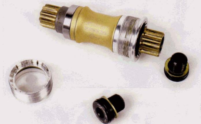
**1** Les boîtiers de pédalier modernes sont simple grâce à leur bloc roulement totalement étanche, avec un côté gauche et droit repéré par les lettres L et R. La cuvette droite comporte un rebord d'appui sur le cadre, contrairement à la gauche.
