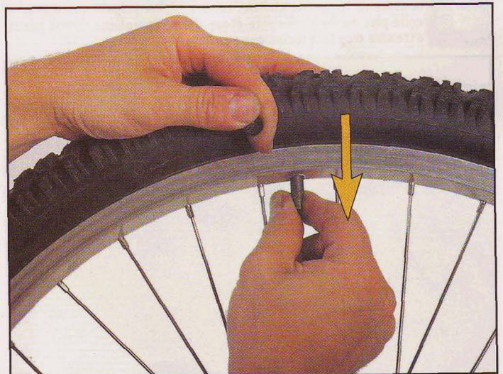
**8** Contrôlez le pneu tout autour de la jante. Il doit toujours être à la même hauteur par rapport à celle-ci. La chambre ne doit pas être coincée entre le talon et la jante. Poussez et tirez sur le pneu pour supprimer ces défauts éventuels. Tirez sur la valve pour la mettre en place totalement. Gonflez à la bonne pression.
