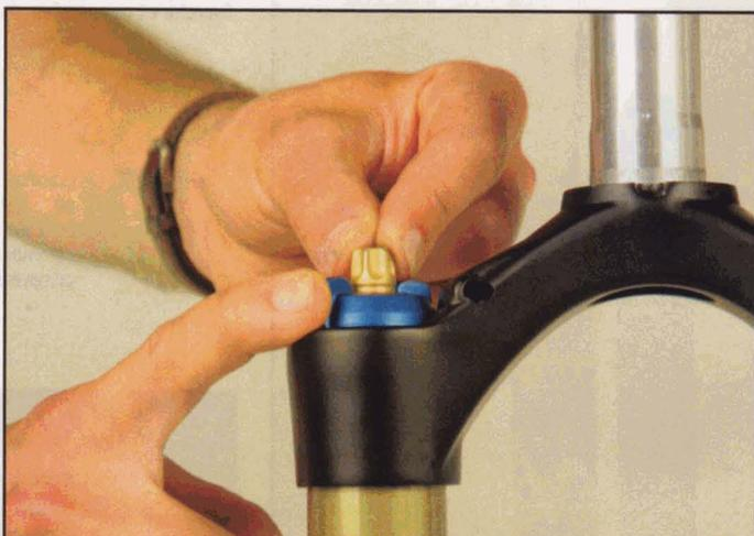
**11** La molette dorée sort de quelques millimètres pour une meilleure prise en main. Tout en maintenant la molette Albert-Select, tournez dans le sens des aiguilles d'une montre („,+“ pour augmenter le seuil de sensibilité du système "Plateforme".
