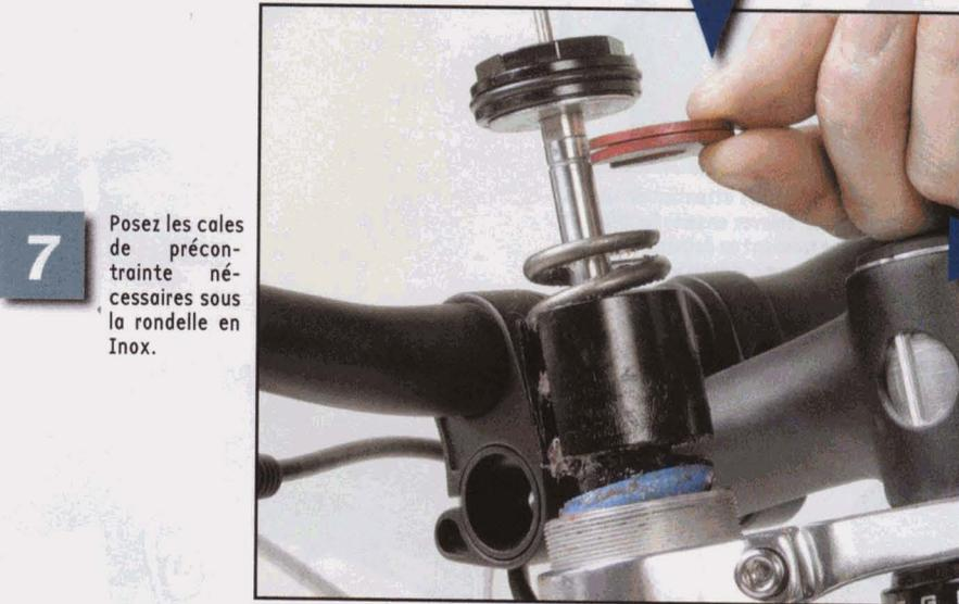
**7** Posez les cales de précontrainte nécessaires sous la rondelle en Inox.
