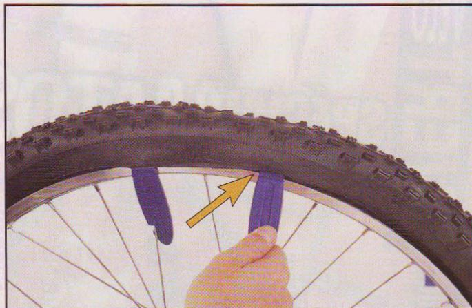
**2** Si votre pneu est trop serré sur la jante, et que vous utilisez des démonte-pneus, placez un premier démonte-pneu sous le talon du pneu et un deuxième à environ 7 ou 8 centimètres.
