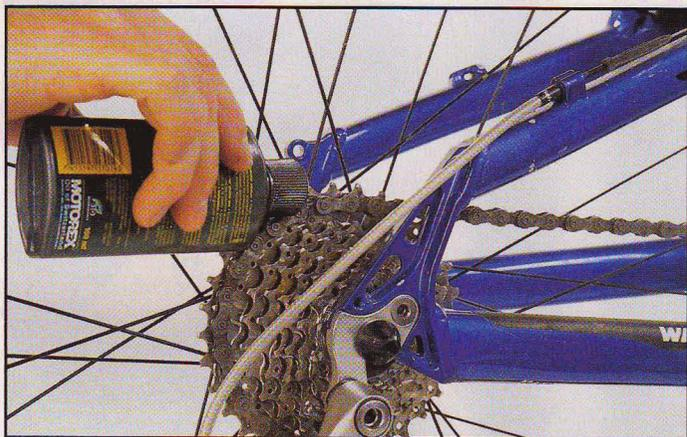
**1** Suivant son degré de dégraissage, huilez la chaîne à l'aide d'une burette ou d'une bombe. Une huile minérale fluide est suffisante. Pour un usage intensif, utilisez un lubrifiant spécialisé au Teflon, moins collant et moins salissant.
