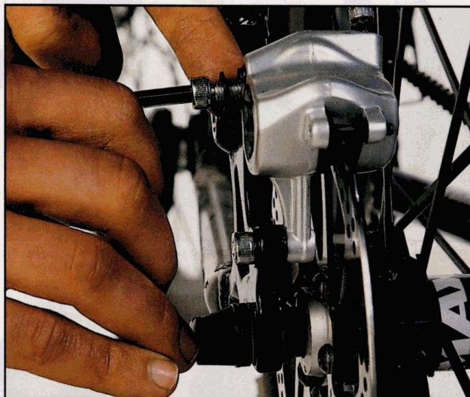
**2** Au montage définitif, placez en plus une entretoise sous la tête de chaque vis de fixation, pour réduire les vibrations. Vérifiez que le disque passe au centre de la fente de l'étrier, à égale distance des plaquettes, et serrez les vis de fixation de l'étrier.
