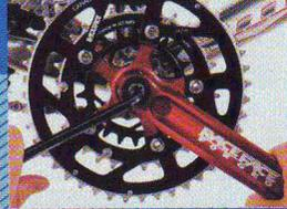
Les manivelles du pédalier sont les deux bras supportant les pédales. La droite supporte aussi les plateaux. C'est par elles que le pilote transfère son énergie à la chaîne, puis à la roue arrière.
