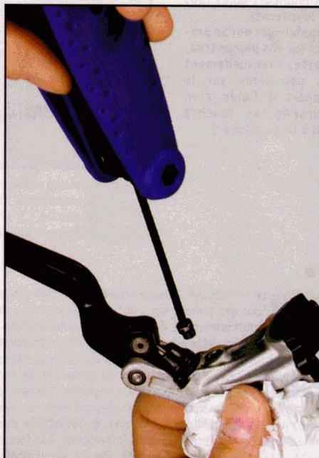
**3** Dévissez les deux vis BTR (3 mm) de la bride du maître-cylindre et démontez la manette du guidon. Dévissez ensuite la petite vis Torx (clef Torx de 10) et vissez l'autre seringue du kit, vide, à sa place.
