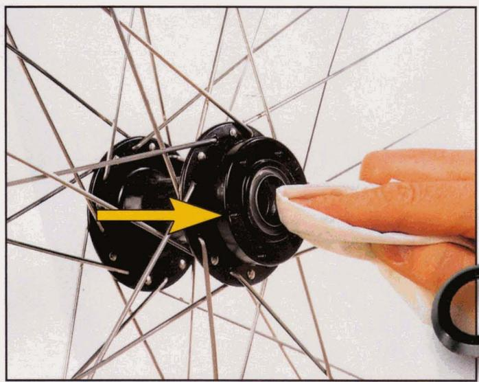
**7** Nettoyez les cuvettes des moyeux avec un chiffon propre. Si elles sont trop marquées (rugueuses au toucher), il faut malheureusement changer ces derniers. Nettoyez l'axe et les billes.
