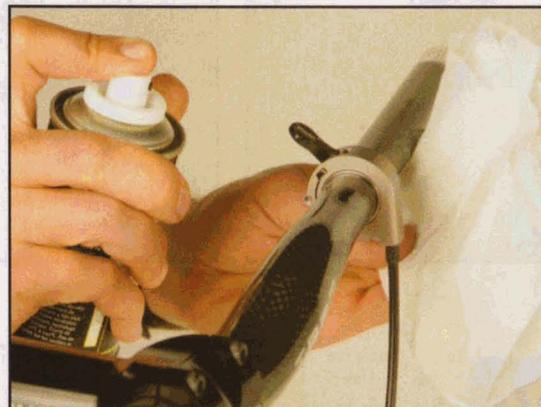
**4** Lubrifiez tous les mois ou après une sortie boueuse la molette et la commande du blocage de compression.
