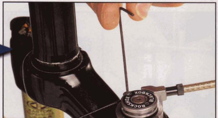
**11** Passez le câble dans le Remote Control en position "ouvert" et serrez-le avec une clé Allen de 1,5 mm. La molette de tension permet de garder le câble parfaitement tendu.
