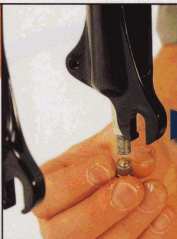
**1** Avant de régler la fourche, commencez par une remise à zéro des deux chambres d'air. Appuyez sur les pointeaux des valves avec leur bouchon. Il ne faut pas totalement dégonfler les chambres avec le bouton d'ajustement de pression situé sur la pompe à haute pression ; la vieille graisse, qui serait ainsi propulsée dans la pompe, serait ensuite réinjectée dans la fourche.
