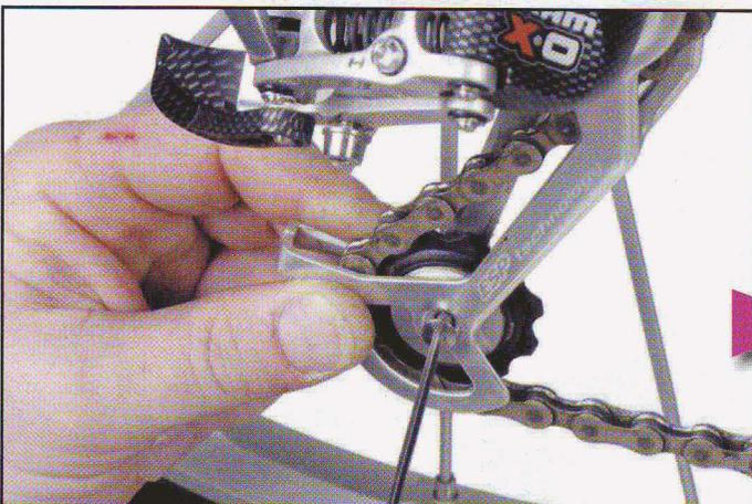
**9** Resserrez et bloquez l'axes du galet. Au besoin, mettez du frein-filet sur les filetages.
