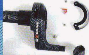
Les Grip-Shift de nouvelle génération ont vu leur fonctionnement nettement amélioré. Du coup, il n'est plus nécessaire de les démonter aussi fréquemment. Le changement de câble est également simplifié.
