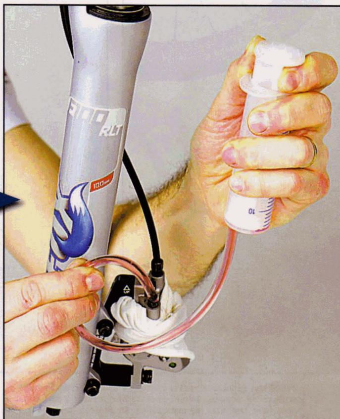
**9** Assurez-vous que le levier de frein offre un toucher suffisamment raide. S'il manque de raideur, desserrez à nouveau la vis de purge et réinjectez encore un peu d'huile, jusqu'à obtenir un levier assez ferme. Déconnectez le flexible de l'étrier, essuyez la vis de purge et l'étrier s'il a été souillé, et recapuchonnez la vis.
