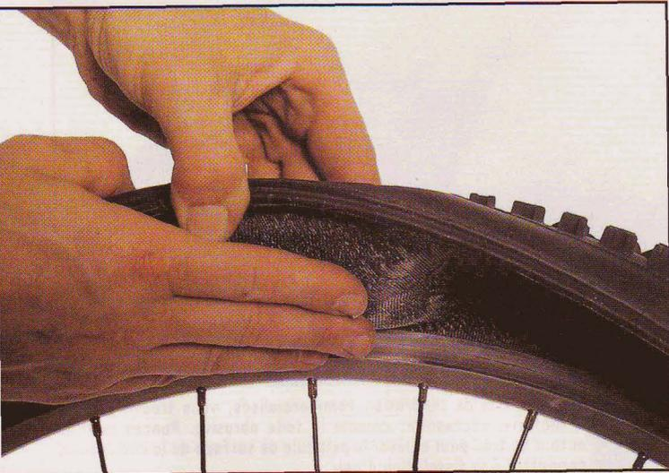
**5** Si vous n'êtes pas absolument sûr d'avoir crevé par pincement de la chambre (écrasement de la chambre entre un obstacle et la jante), faites une rapide vérification de l'intérieur du pneu. Frottez la face interne de la carcasse à la main, pour détecter d'éventuels corps étrangers (épine, clou...), et retirez-les.
