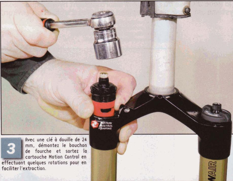
**3** Avec une clé à douille de 24 mm, démontez le bouchon de fourche et sortez la cartouche Motion Control en effectuant quelques rotations pour en faciliter l'extraction.
