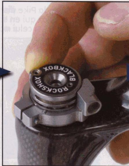
**6** Positionnez le capuchon sans remettre le ressort et tournez en arrière jusqu'au repère orienté à 12 heures, pour préréglage la bonne tension du ressort. Enlevez le capuchon.
