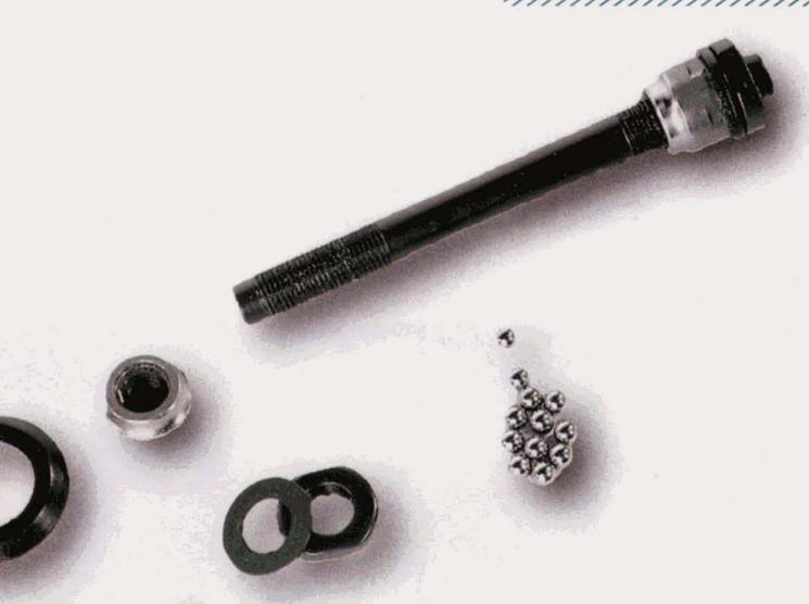
**8** Si le chrome des billes ou des cônes est attaqué (rugueux au toucher), changez ces derniers. Les cônes sont les chemins de roulement des billes. En les vissant sur l'axe, on règle le jeu. Les contre-écrous bloquent le tout et servent de surface d'appui sur le cadre.
