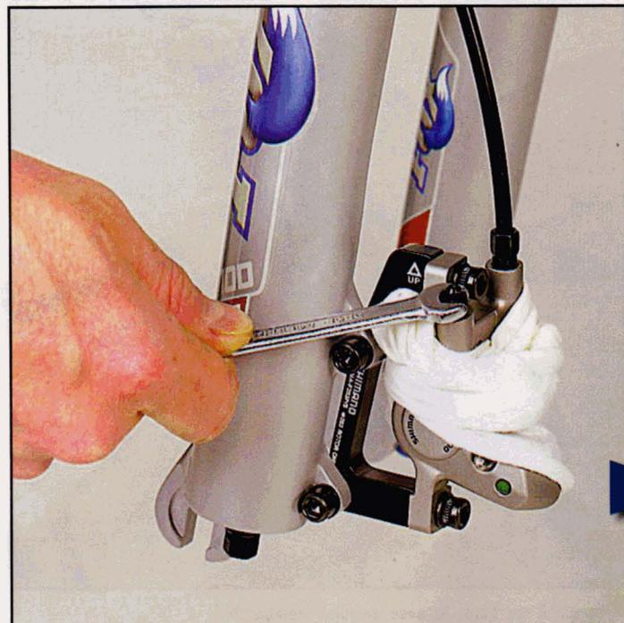
**6** Après avoir ôté le capuchon en caoutchouc, desserrez la vis de purge de l'étrier avec une clé plate de 8 mm ; un quart de tour suffit. Connectez le flexible de la seringue sur la vis de purge.
