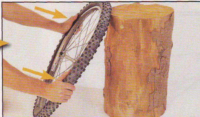
**2** Placez le point le plus désaxé en appui, positionnez vos mains de chaque côté de la déformation et appuyez pour faire revenir la jante vers son centre. La jante fait ressort. Il faut la déformer au-delà de la position correcte pour la redresser.
