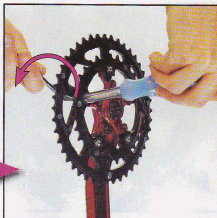
**1** Grand et moyen plateaux sont fixés ensemble sur l'étoile de manivelle droite. Leur démontage est donc indissociable. Desserrez les cinq boulons avec une clé Allen de 5.
