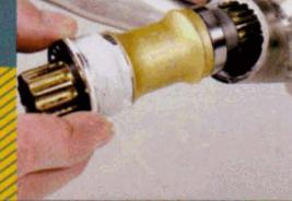
Qui dit cartouche, dit ensemble monobloc unifié, non séparable. Shimano nous prive des joies et avantages du graissage. En contrepartie, l'étanchéité est excellente, le réglage et le démontage très simples !
