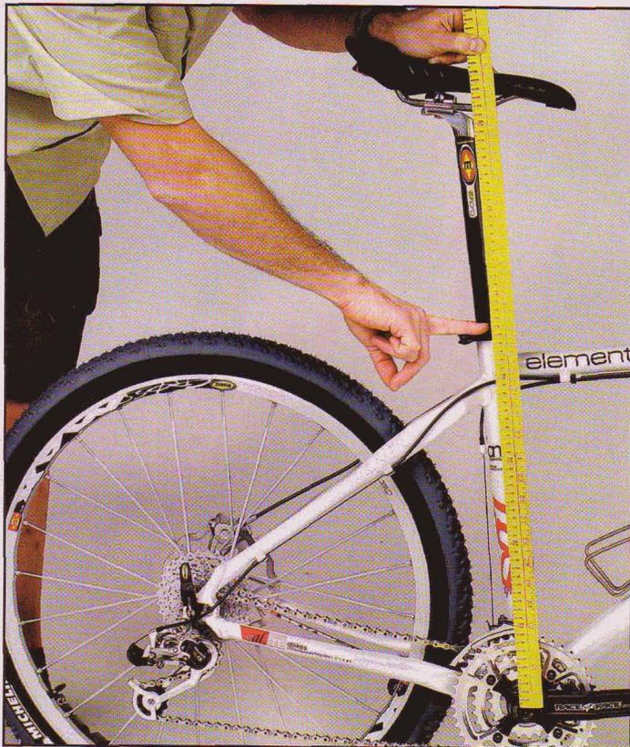
**1** La taille du cadre se mesure entre l'axe du pédalier et celui du tube horizontal, ou le sommet du tube de selle en suivant celui-ci. La taille est également appelée hauteur de cadre.
