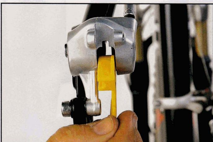
**4** Remplacez ces plaquettes par la cale de transport (jaune) fournie avec le kit et bloquez-la avec un élastique. Pour mettre la Durit à la bonne longueur, desserrez l'écrou-raccord au niveau du maître-cylindre du levier avec une clé plate de 8.
