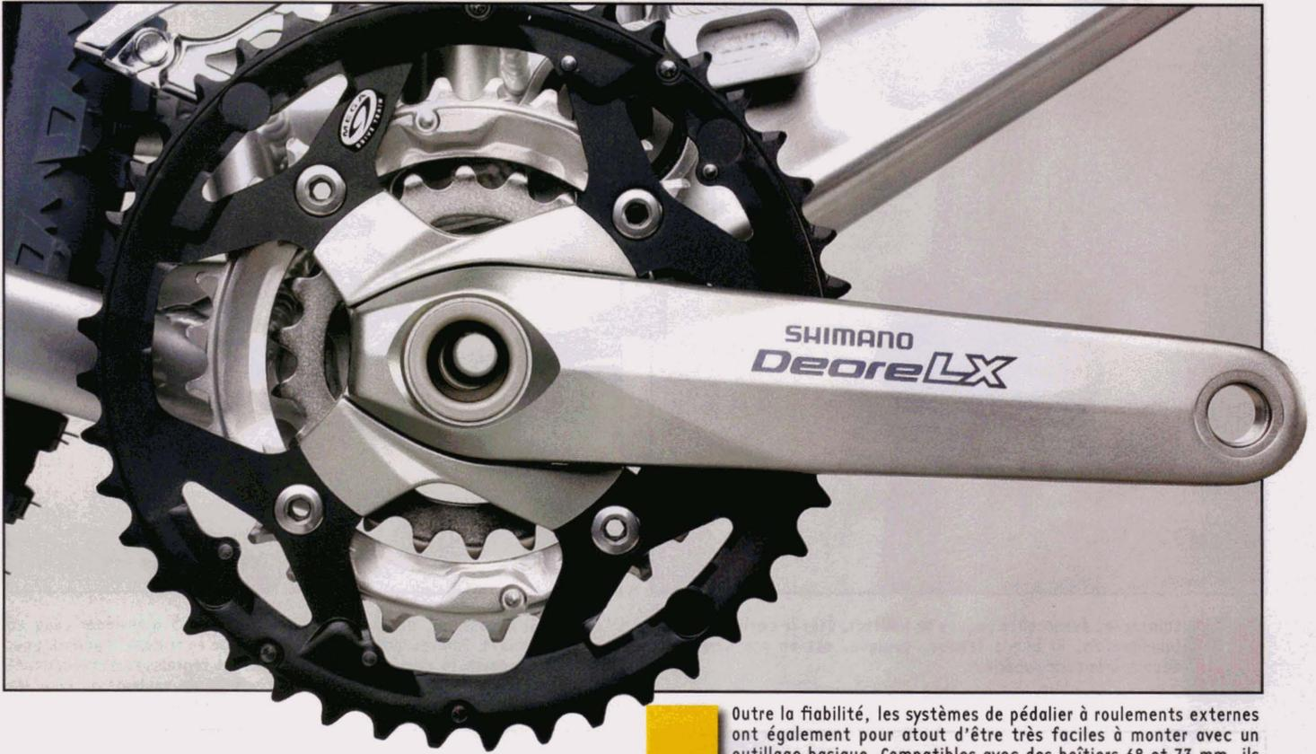
Outre la fiabilité, les systèmes de pédalier à roulements externes ont également pour atout d'être très faciles à monter avec un outillage basique. Compatibles avec des boîtiers 68 et 73 mm, ils sont livrés avec les entretoises de montage nécessaires.
