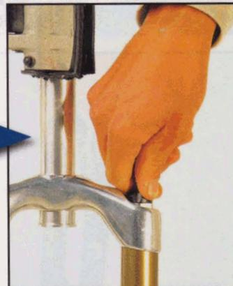
**2** Desserrez la précontrainte en tournant les deux molettes situées au-dessus des deux plongeurs dans le sens inverse des aiguilles d'une montre.
