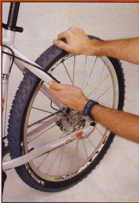
**6** Sur chaque roue, contrôlez le jeu des moyeux. Prenez d'une main le cadre, de l'autre le pneu, et forcez latéralement pour sentir le desserrage éventuel des axes. Vérifiez toujours que vos roues sont serrées dans le cadre et que votre rayonnage n'est pas complètement lâche.
