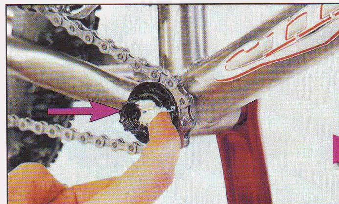
**4** Il faut démonter les manivelles pour changer ou régler le jeu de pédalier, afin de démonter et changer les couronnes de pédalier. Au remontage, lubrifiez, à la graisse ou à la pâte anti-seize, les embouts d'axe et leur filetage.
