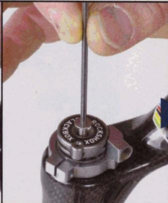
**8** Positionnez le capuchon guide-câble sur le ressort en plaçant le retour de ce dernier dans le trou prévu à cet effet. Serrez avec une clé Allen de 2,5 mm.
