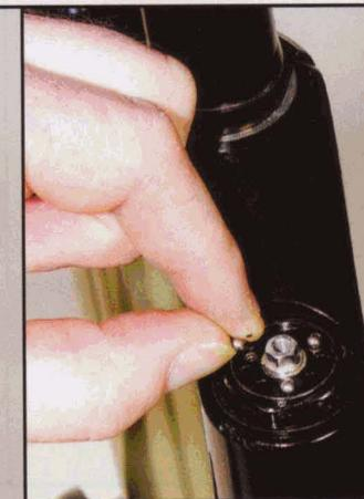
**6** Le remontage se fait à l'inverse après avoir graissé généreusement le nouveau ressort (ce graissage n'est nécessaire qu'en cas de démontage). Remplacez les ressorts avec les billes dessus tous les deux trous du bouchon de fourche.
