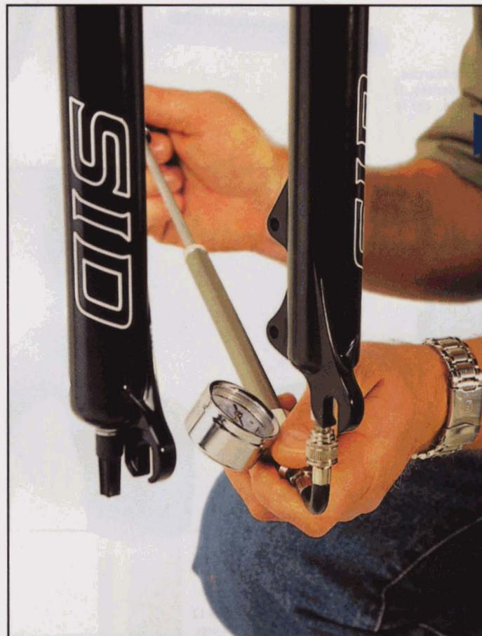
**3** Pour la chambre d'air négative (qui sert à ajuster la sensibilité de la fourche), la préconisation de base doit être modulée en fonction du terrain, par opposition à la chambre d'air positive, dont le réglage est constant. Il ne faut jamais gonfler une chambre d'air négative à une valeur supérieure à la chambre d'air positive (env. 20 PSI de moins).
