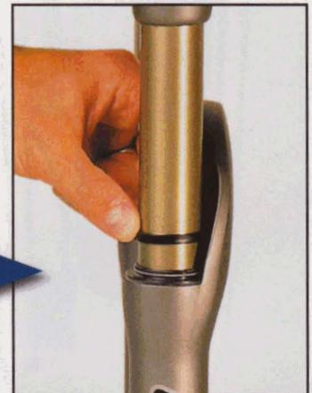
**3** Cerclez un plongeur avec un collier Rilsan au-dessus du joint d'étanchéité. Enfoncez le vélo sans à-coups. Mesurez le déplacement du collier sur le plongeur. Gonflez jusqu'à obtenir l'affaissement au repos (SAG) désiré (voir tableau). Revissez le bouchon protège-valve.
