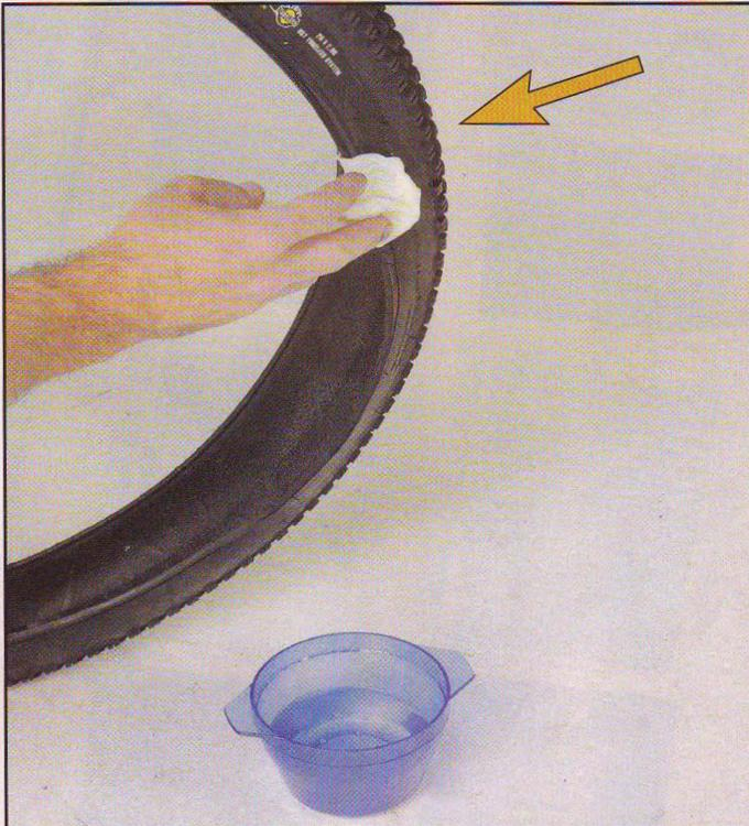
**1** Pour le montage correct d'un Tubeless, l'étape indispensable est de lubrifier les talons du pneu. Pour cela, il vous faudra utiliser de l'eau savonneuse et surtout pas de corps gras. Ainsi lubrifiés, les talons se placeront parfaitement au fond de la jante.
