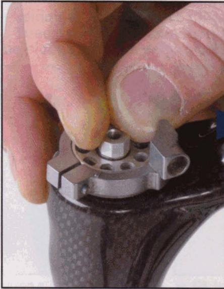
**5** Positionnez à la main le pointeau en position fermée en tournant la petite tête hexagonale en alu dans le sens des aiguilles d'une montre. Ne jamais utiliser d'outil.
