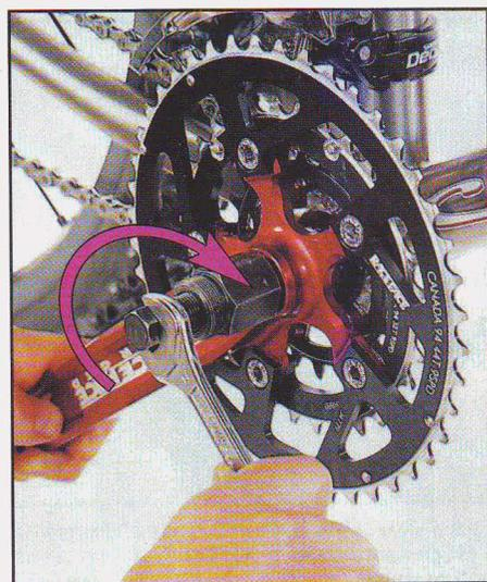
**2** Vissez l'extracteur à fond dans le corps de manivelle. Le boulon central doit être dévissé, pour que l'extracteur puisse aller au fond de la manivelle. Pour cela, vissez le boulon central. Il agit comme un tire-bouchon, en prenant appui sur l'axe de pédalier.
