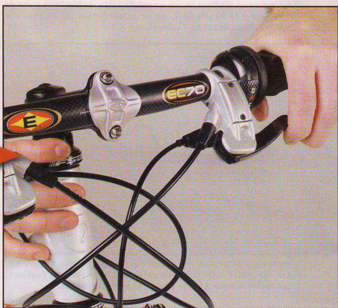
**11** Frein avant serré, poussez sur le guidon pour sentir si le jeu de direction est desserré. Vérifiez son état en tournant le guidon, roue avant en l'air. Si vous sentez des crans, démontez pour vérification.
