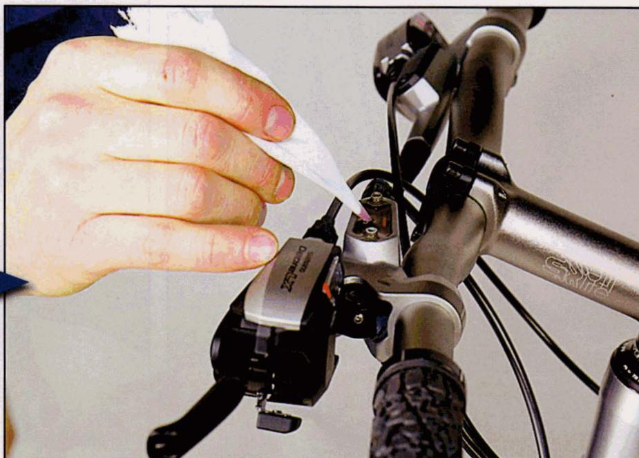
**11** Si le réservoir est rempli à ras bord, la pose du joint-membrane fera déborder l'huile. Trempez une pointe de chiffon propre dans le réservoir pour en absorber un peu.
