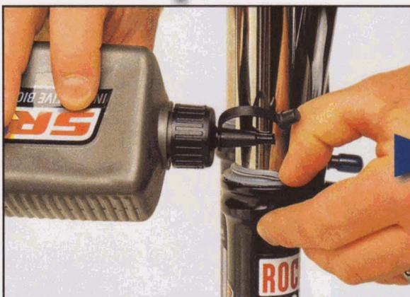
**3** Lubrifiez les joints avec un mélange maison spécial Rock Shox, constitué à 50 % de liquide hydraulique et à 50 % de RED RUM.
