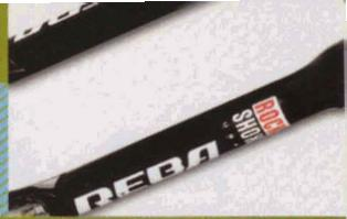
Prévue pour un usage polyvalent, la Reba dispose du système d'amortissement hydraulique Motion Control. Une purge de ce système est à prévoir toutes les 100 heures d'utilisation environ.
