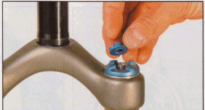
**1** Pour régler la précontrainte d'une Float, dévissez le bouchon (en aluminium bleu) qui coiffe le plongeur gauche (sur les modèles Talas, dévissez uniquement le couvre-valve central). Pour une Vanilla, il suffit de tourner ce même bouchon - qui est alors une molette -, pour obtenir la précontrainte de ressort voulue.
