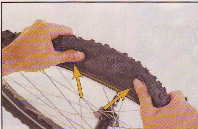
**1** Démontez la roue du cadre. Pincez le pneu en rapprochant ses deux flancs pour le décoller de la jante. Ainsi, les talons (bords du pneu) vont se trouver en face de la partie creuse de la jante. Cela suffit parfois pour sortir le pneu. Sinon, vous pourrez facilement glisser les démonte-pneus.
