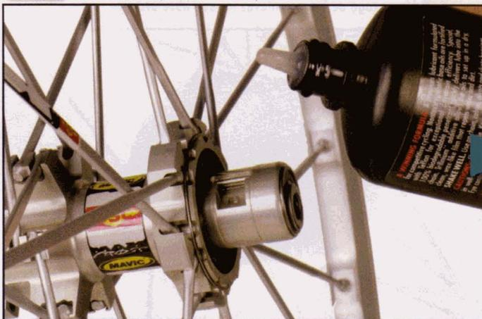
**6** Relubrifiez abondamment les corps supports, ainsi que la roue libre, avant de remonter dans le sens inverse tout le système sans oublier de replacer la rondelle à sa place.
