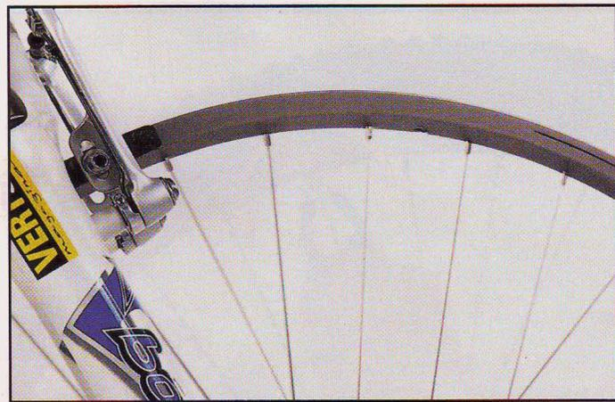
**8** Faites tourner la roue pour vérifier que le dévoilage est correct. Surtout, ne brûlez pas d'étape : un premier tour de roue pour dévoiler (tension, et desserrage éventuel à l'opposé), un deuxième passage pour le contrôle de la tension.
