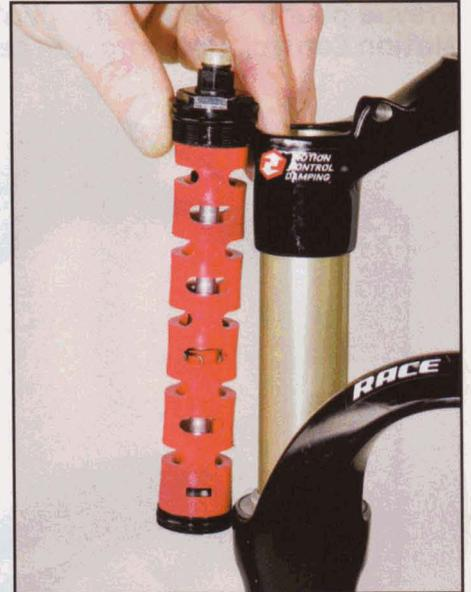
**4** La cartouche sortie, vérifiez l'état des joints à chaque extrémité et videz la vieille huile dans un récipient en pompant pour vider complètement le système.
