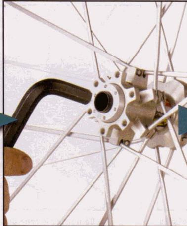
**2** Introduisez une clé Allen de 10 dans le moyeu, côté opposé au corps de roue libre.
