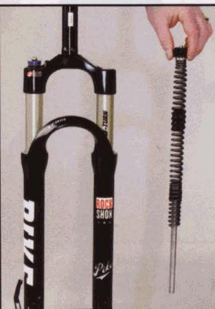
**5** Avec une clé à pipe ou plate de 24 mm (l'idéal est une clé à douille 6 pans), dévissez le bouchon supérieur de la fourche et sortez le ressort.
