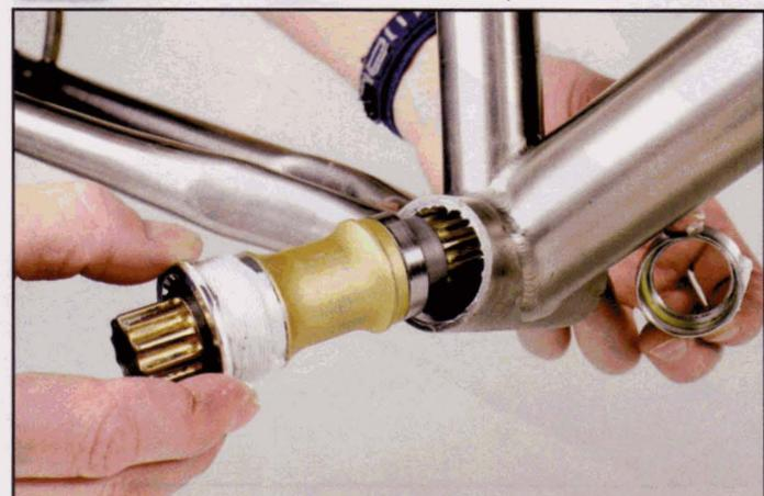
**5** Au remontage, graissez les filetages et l'intérieur de la cuvette mobile. Introduisez le boîtier cartouche, vissez aux 2/3 la cuvette fixe. Placez la cuvette opposée, commencez à la visser. Vous pouvez serrer et bloquer la cuvette fixe avec l'outil cannelé.
