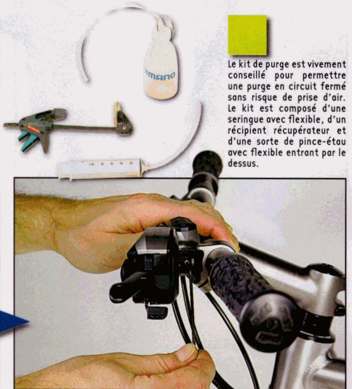
Le kit de purge est vivement conseillé pour permettre une purge en circuit fermé sans risque de prise d'air. Le kit est composé d'une seringue avec flexible, d'un récipient récupérateur et d'une sorte de pince-étoupe avec flexible entrant par le dessus.
