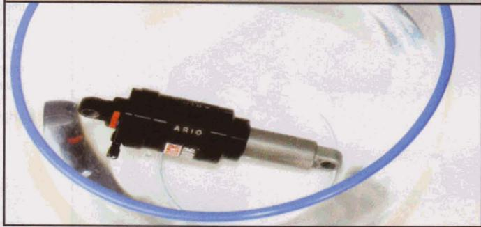
**5** Regraissez les différents joints (utiliser de préférence du Judy Butter de Rock Shox et surtout pas une graisse au lithium !). Remontez à l'inverse en veillant à ne pas pincer les joints. Pour vérifier l'étanchéité de l'amortisseur, mettez-le en pression puis plongez-le dans une bassine d'eau. Il ne doit pas perdre d'air, donc faire de bulles.
