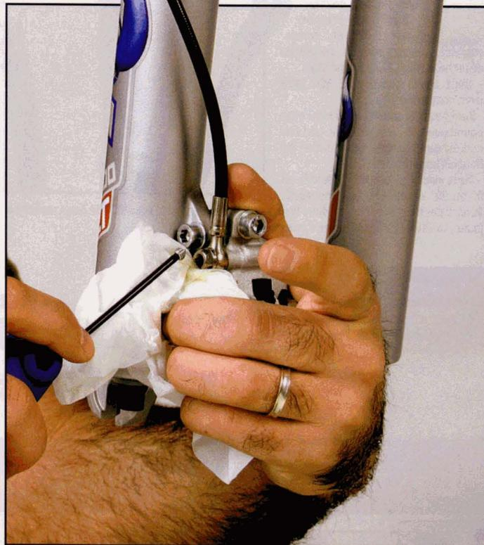
**1** Commencez par enlever la roue et protégez l'étrier pour limiter tout risque de contamination du disque et des plaquettes. Démontez la vis Torx (à l'aide d'une clef Torx de 10) située dans la vis banjo de l'étrier de frein (soyez attentif au petit joint torique ; par précaution, il vaut mieux le retirer et le remplacer après la purge).
