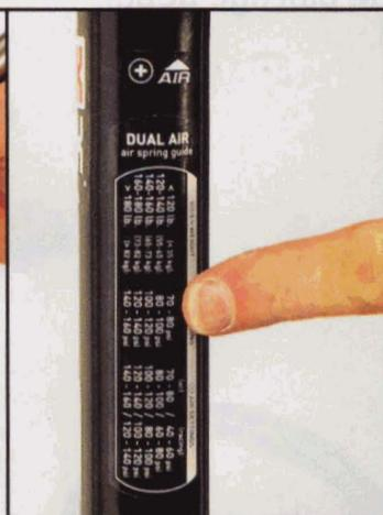
**2** Pour remettre les chambres d'air en pression, regonflez en premier la chambre positive, via la valve située sur le haut du plongeur gauche, avec la pompe à haute pression Rock Shox. Sur les fourches 2004, les pressions préconisées sont indiquées sur le fourreau gauche. Pour les modèles précédents, reportez-vous au tableau. Petit conseil : mettez toujours 10 PSI supplémentaires car c'est sensiblement la perte quand on débranche la pompe.
