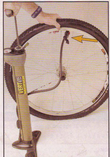
**4** Vérifiez que le pneu est bien positionné sur la jante, sur toute la circonférence. Gonflez-le jusqu'à 4 bars pour que les talons se logent correctement dans la jante. Vous devez d'ailleurs entendre plusieurs claquements qui indiquent la mise en place. Ajustez ensuite la pression en fonction de votre poids et du terrain.
