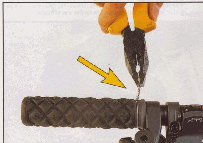
**5** Un truc issu du motocross : prenez du fil de diamètre 1,5 ou 2 mm, très souple, torsadez-le à l'aide d'une pince et repliez les torons dans la matière de la poignée. Vos poignées collées et assurées au fil de fer ne craignent aucun lavage !
