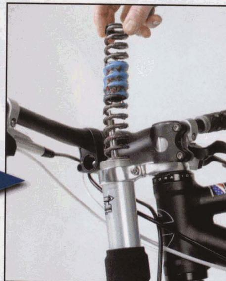
**10** Sortir le ressort. La couleur du manchon en plastique indique sa dureté. Le remontage se fait à l'inverse et le resserrage du capuchon se fait avec modération.
